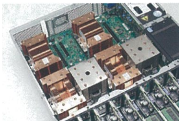
※日立製 SR24000/DL1 ディープラーニングシステム 筐体内部写真
