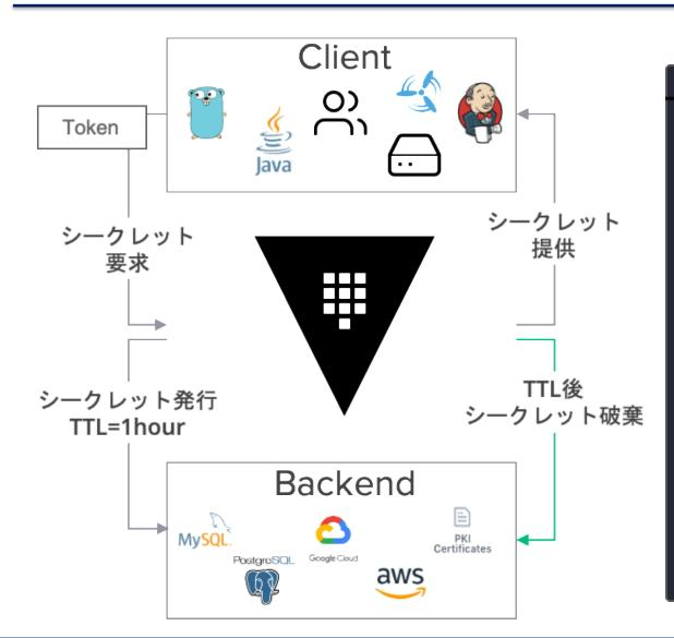
Terminal ullet\$ vault read database/creds/mysql-role → <u>VaultがDatabaseのSQLを実行し、ユーザとパスワードを発行</u> \$ vault read aws/creds/vpc-admin → <u>VaultがAWS API実行し、IAMキーを発行</u> \$ vault read ssh/role/otp → <u>VaultがVM</u>上でシェルを実行し、SSHパスワードを発行 \$ vault write pki\_intermediate/issue/kabuctl-dot-run ¥ common\_name="blog.kabuctl.run" → Vaultが認証局となり、証明書を発行
