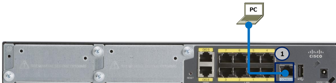
図 2 パスワードの回復で使用する構成 (C841M-8X-JAIS/K9 の場合)
